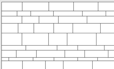
Die Steine werden mit mindestens 3 Schiefnägeln- oder stiften, bei Steinbreiten > 30 cm mit entspr. 4 Schiefnägeln- oder stiften, nur innerhalb der Höhenüberdeckung befestigt.
